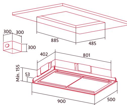
Installation du moteur indépendant de la hotte à une distance maximale de 5 m (avec le câble fourni) ou 10 m (avec l'accessoire)
